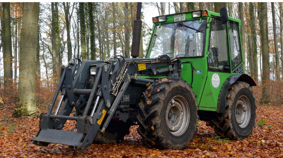
Der C870 von Georg Nesselrode ist ein relativ junger Holder aus dem Baujahr 1999, und damit einer der letzten aus dieser Baureihe. Ausgestattet mit Frontlader, Kabine, Dreipunkt und Heckzapfwelle beträgt sein zulässiges Gesamtgewicht 4.500 Kilogramm, zuzüglich einer hydraulisch oder pneumatisch gebremsten Anhängerlast von 12.000 Kilogramm. Zum Antrieb des Allrad-schleppers mit Knicklenkung und vier gleich großen Rädern steht ein Gruppengetriebe mit zwölf Vorwärts- und vier Rückwärtsgängen zur Verfügung. Die Höchstgeschwindigkeit beträgt etwa 30 Kilometer pro Stunde.
