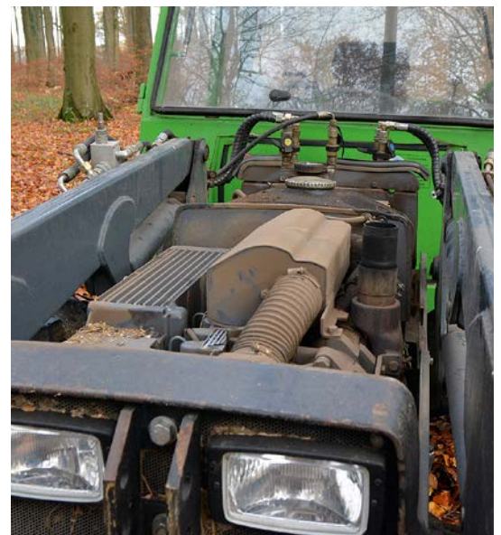
Wenn der Auspuff abmontiert ist, kommt unter der Motorhaube der Deutz-Motor zum Vorschein. Der Vierzylinder-Viertakt-Motor holt aus 2.732 Kubikzentimetern Hubraum 70 PS und ist mit einer Öl-Luftkühlung ausgestattet.
