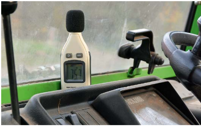
Die Dezibel-Messungen ergaben an allen Messpunkten wie hier in der Kabine eine verringerte Lautstärke.
