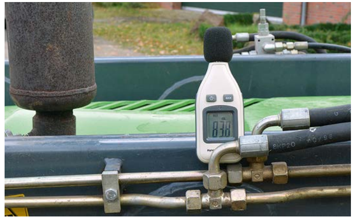
Direkt neben dem Auspuff nahm die Lautstärke um 2,2 Dezibel ab. Diese Minderung macht sich beim menschlichen Gehör bereits stark bemerkbar.
