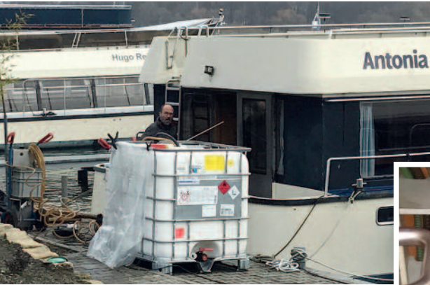
Vor der Reinigung wird der alte Diesel vollständig abgepumpt.
