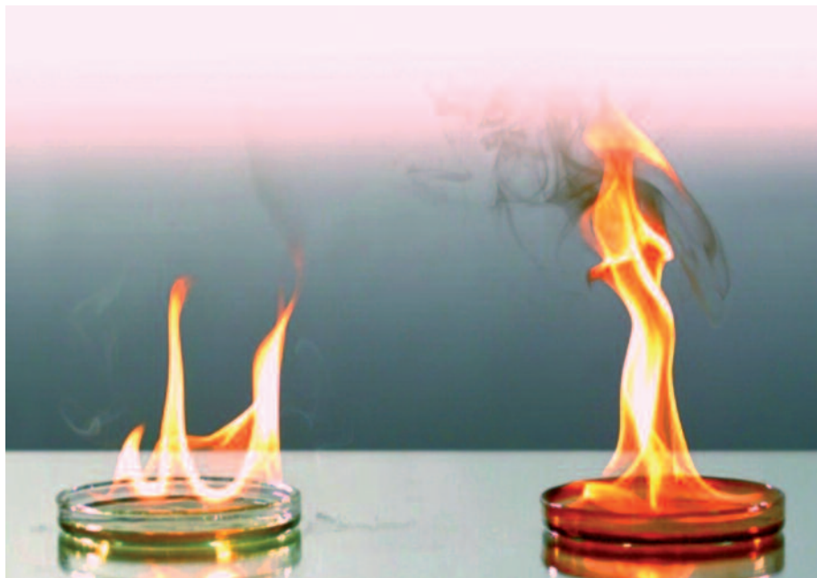
Verbrennt ohne die typische Rußbildung: Der neue Dieseldieselkraftstoff schont neben der Umwelt auch Crew, Boot und Motor
