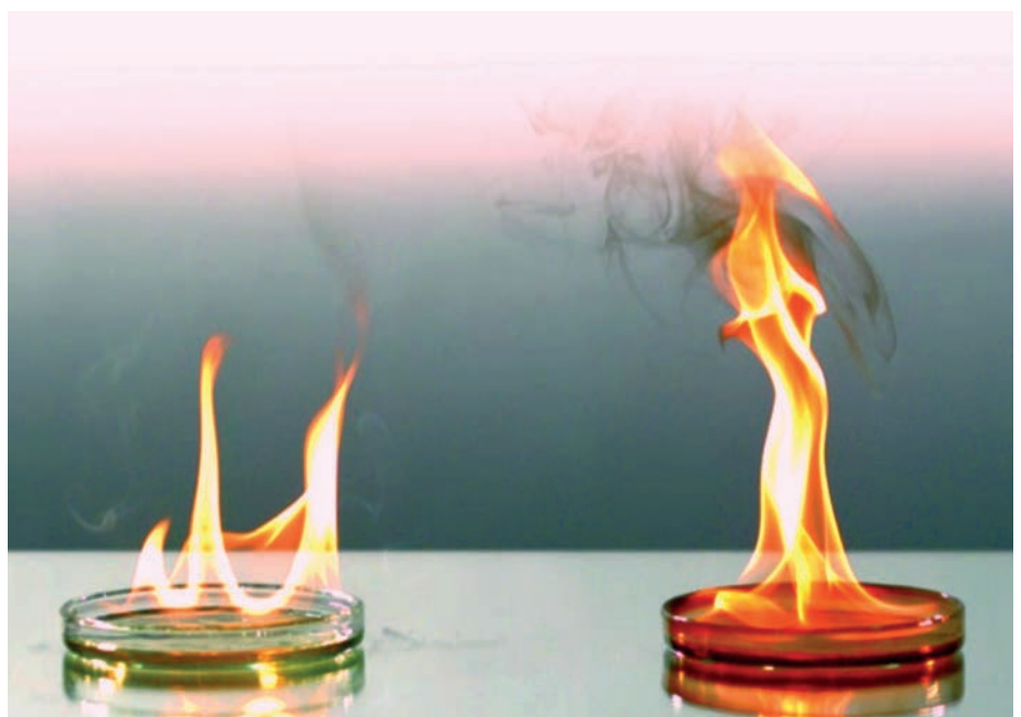
SeaHelp hat es ausprobiert: Schon in der Schale verbrennt C.A.R.E. Diesel im Vergleich zu bisher handelsüblichem Diesel wesentlich rußärmer, weil ihm die Aromaten fehlen.
