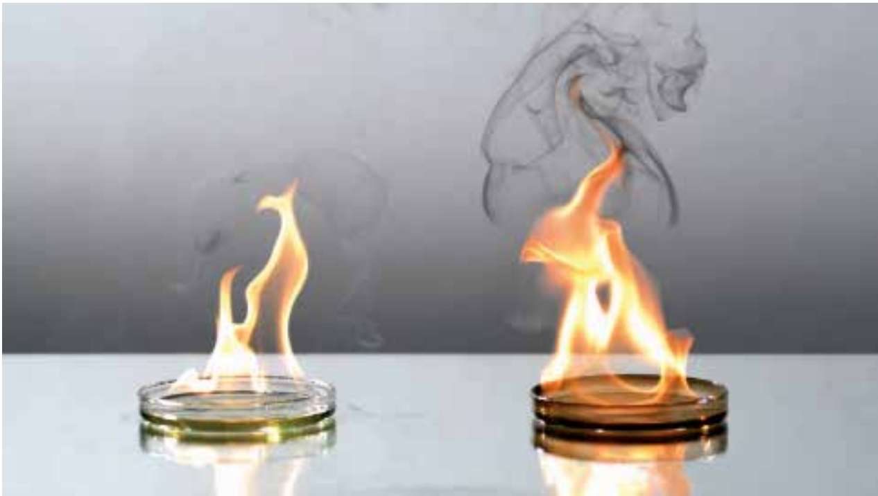
Dieses Bild veranschaulicht schön die verbrennungsbezogenen Qualitäten des NExBTL. Links eine Schale mit dem neuen Biodiesel, rechts wird mineralischer Diesel verbrannt. Es sieht so aus, als könnte man riechen, dass die linke Schale auch deutlich weniger Geruch produziert.
